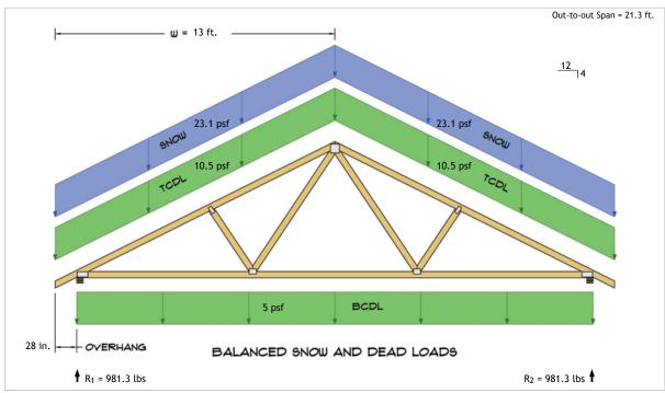
$$\begin{split} R_1 &= D + S = 380.7 \text{ lbs} + 600.6 \text{ lbs} \\ R_2 &= D + S = 380.7 \text{ lbs} + 600.6 \text{ lbs} \end{split}$$
