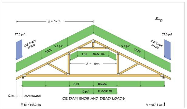
$$\begin{split} R_1 &= D + S = 513.3 \text{ lbs} + 154.0 \text{ lbs} \\ R_2 &= D + S = 513.3 \text{ lbs} + 154.0 \text{ lbs} \end{split}$$
