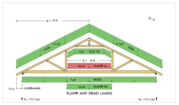
$$\begin{split} R_1 &= D + L = 513.3 \text{ lbs} + 200.0 \text{ lbs} \\ R_2 &= D + L = 513.3 \text{ lbs} + 200.0 \text{ lbs} \end{split}$$
