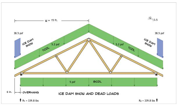
$$\begin{split} R_1 &= D + S = 301.3 \text{ lbs} + 38.5 \text{ lbs} \\ R_2 &= D + S = 301.3 \text{ lbs} + 38.5 \text{ lbs} \end{split}$$
