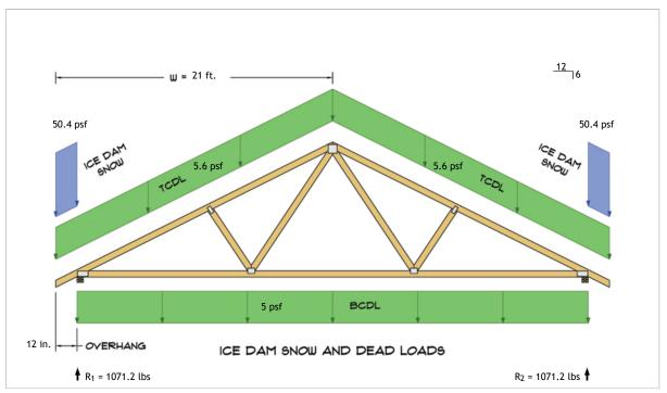
$$\begin{split} R_1 &= D + S = 869.6 \text{ lbs} + 201.6 \text{ lbs} \\ R_2 &= D + S = 869.6 \text{ lbs} + 201.6 \text{ lbs} \end{split}$$
