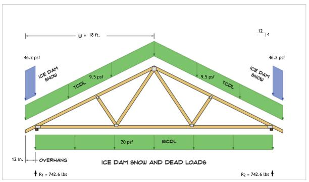
$$\begin{split} R_1 &= D + S = 681.0 \text{ lbs} + 61.6 \text{ lbs} \\ R_2 &= D + S = 681.0 \text{ lbs} + 61.6 \text{ lbs} \end{split}$$
